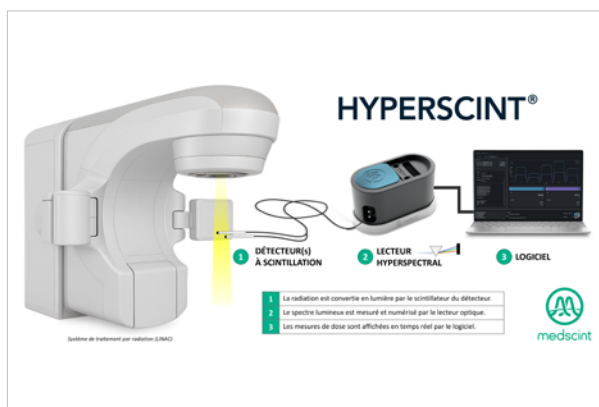
Figure 3 : Schéma explicatif de la solution de dosimétrie HYPERSCINT développée par Medscint pour la radiothérapie.
