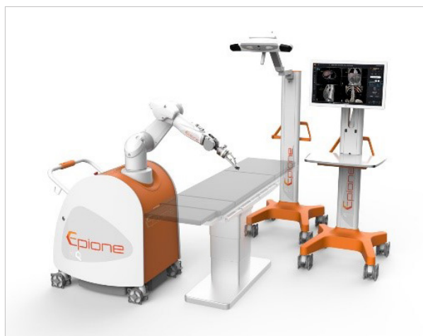
Figure 3 : Robot Epione®, utilisé lors des ablations percutanées des tumeurs.
