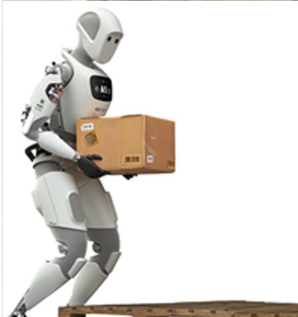
Figure 8 : Le robot modulaire Apollo A1, conçu pour le transport de bacs et le déchargement de cartons.
