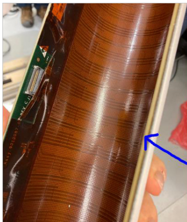
Figure 4 : Intérieur du patient contact pour un détecteur de Veriton.
