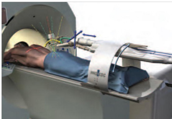
Figure 6 : Robot Innomotion pour procédures guidées par IRM.
