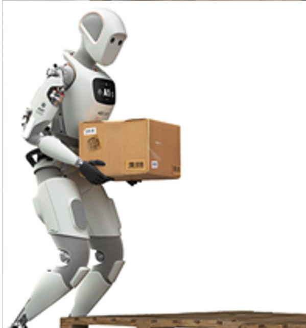
Figure 9 : Le robot modulaire Apollo A1, conçu pour le transport de bacs et le déchargement de cartons.
