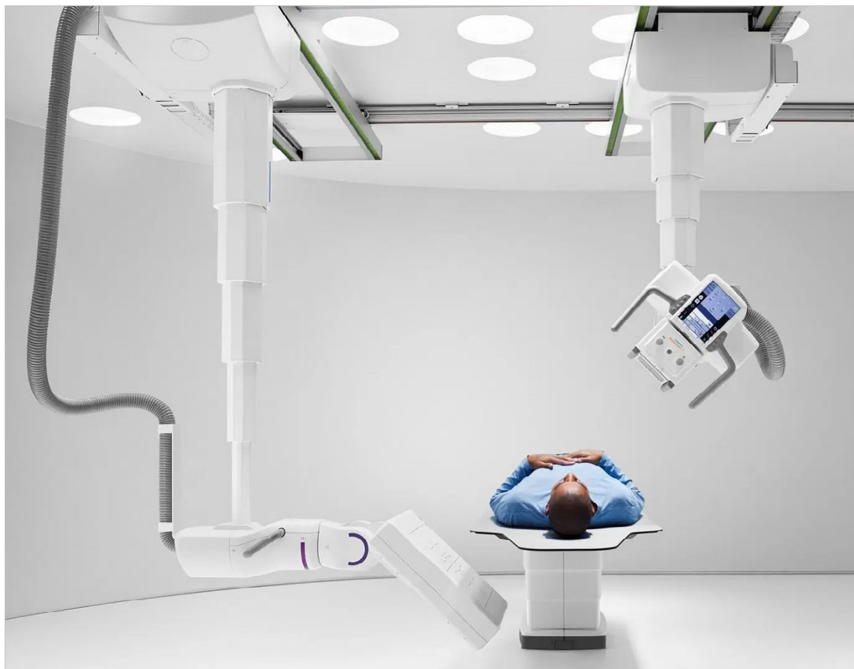
Figure 4 : Exemple de système robotisé en radiographie (Multitom Rax).
