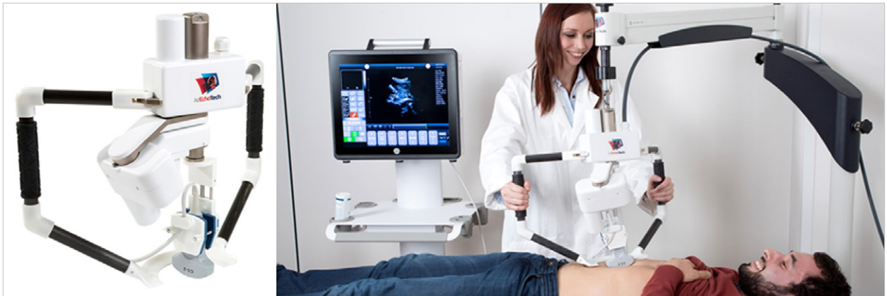
Figure 7 : Melody, une solution robotisée d'échographie à distance : un professionnel de la santé maintient le robot sur le patient pendant que l'échographiste à distance manipule la sonde.
