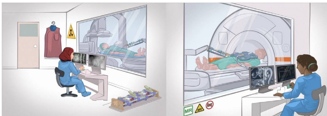
Figure 5 : Utilisation, à distance, d'une plateforme robotisée à l'intérieur d'une salle d'IRM pour guider une intervention.
