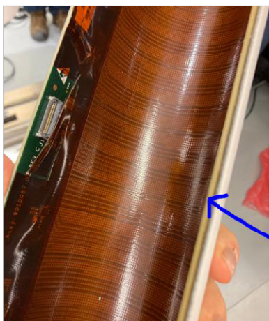
Figure 4 : Intérieur du patient contact pour un détecteur de Veriton.
