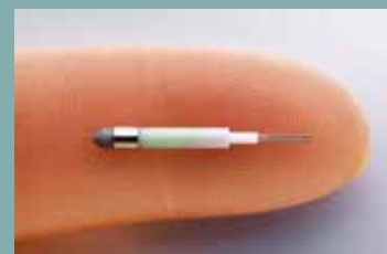
Figure 5 : Tube à rayons X miniature de 50 kV. ( http://www.xoftinc.com )
