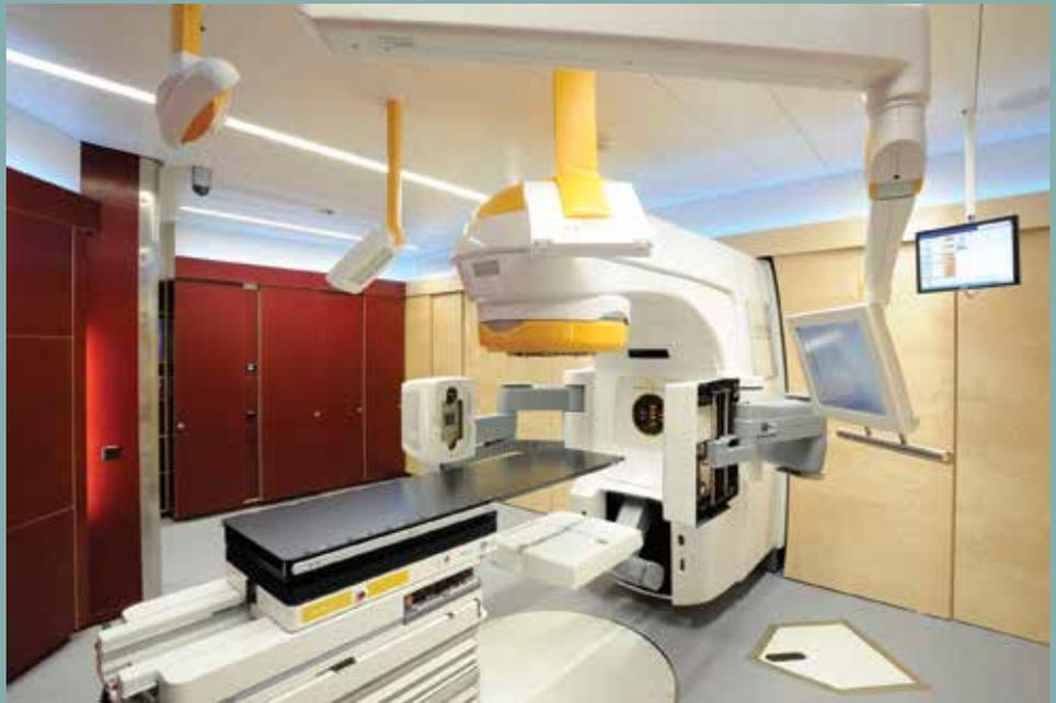
Figure 1: Novalis Tx équipé d'un système d'imagerie et d'une table robotisée.
