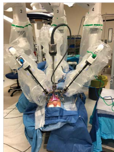
Figure 2 : Vue des trois bras du robot, celui du milieu portant la caméra HD, les bras de gauche et de droite, le monopolaire et le dissecteur
