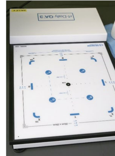
Figure 2 : Appareil de mesure pour vérifier quotidiennement la qualité des faisceaux de radiation avant de commencer les traitements.
