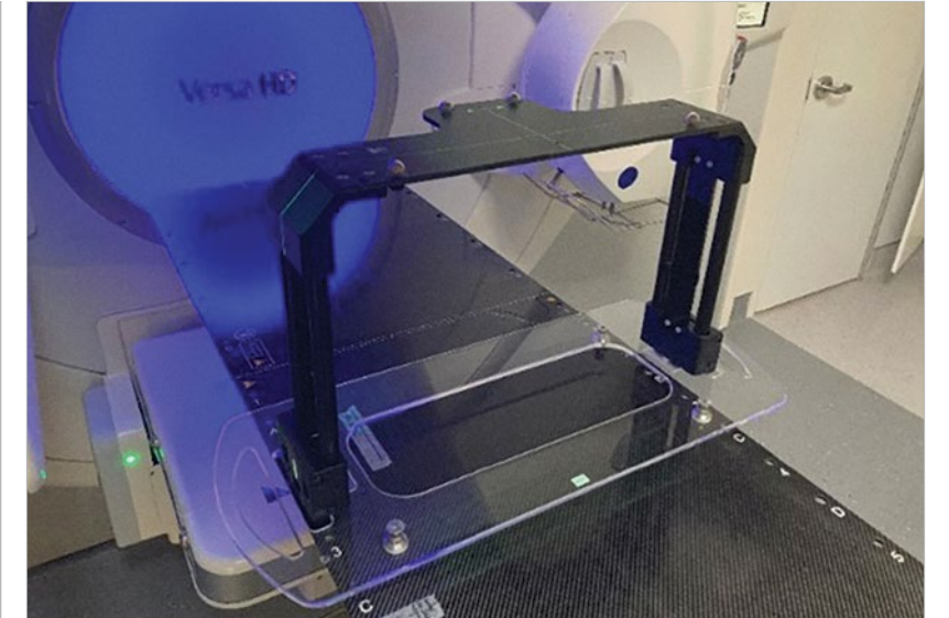
Figure 3 : Accessoires de vérification quotidienne des mouvements de rotation de la table de traitement.
