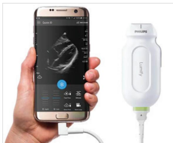
Figure 6: Composantes de l'application Lumify: téléphone intelligent et transducteur à ultrasons.
