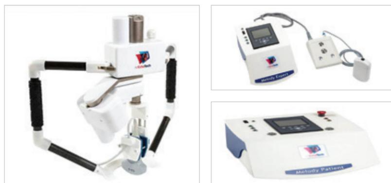
Figure 2: Les composants de la télé-échographie robotisée.
