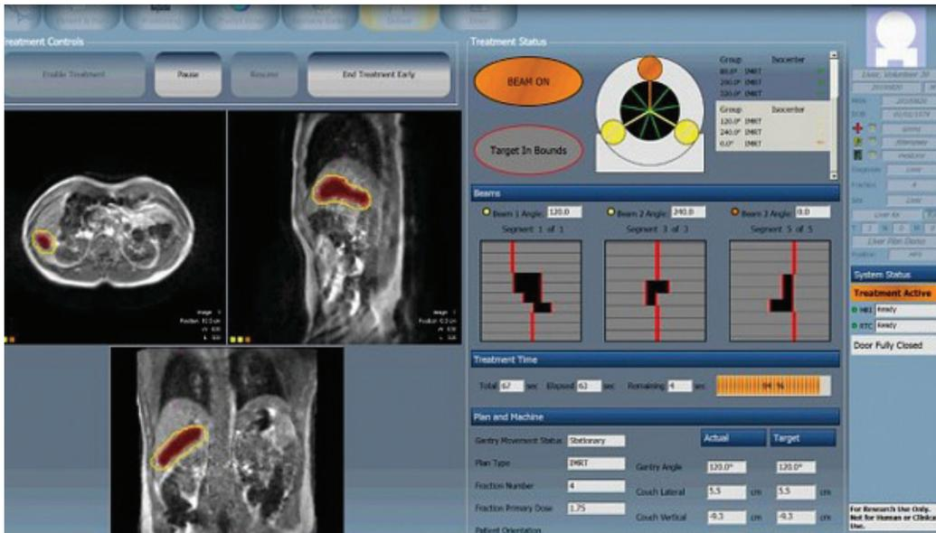
Figure 4: Exemple d'interface d'une console d'un appareil de traitement combinant la résonance magnétique et un accélérateur linéaire.<sup>4</sup>
